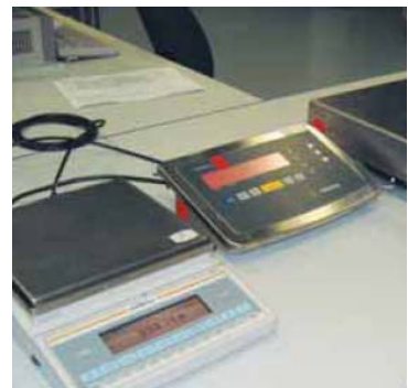
计数大批量特别小的零配件的称量计数组合，包括 60-kg Combics CW2P1-30fe-1 秤和 FC6CCE-H 参比秤
