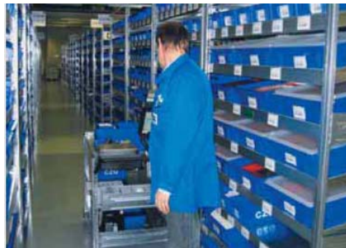
操作员正在使用移动滚轮桌收集客户订购单中的零部件，需要的数量通过赛多利斯 QC7DCE-S 计数
