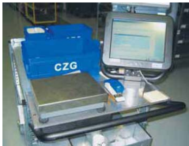
移动滚动桌的一部分，QC 工业秤（秤台和显示器）以及赛多利斯 YRB06Z 外部可充电电池，桌上还装有触摸屏、电池和条形码扫描仪
