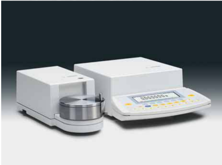
SE2-F 超微量天平分辨率从 0.1\ \mu\text{g} 到 2.1\text{g} ，适合测量 50mm 直径的过滤器（可选用于 90mm 的排气管托盘）
