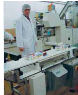
Grabower Süßwaren 的经理站在赛多利斯 OBSERVER™ 前，OBSERVER™ 能检查蛋白巧克力包装中的金属污染物
