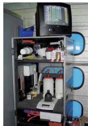
为了得到最好的状态，用 TE 天平记录制动闸的重量数据
