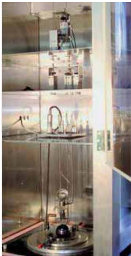
测试塔中测量固体密度的系统，可以看用于提升砝码、放置铅锤和待测物体的部分
