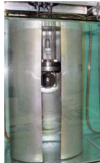
挡板（分隔板）和特殊的进出口管可以减少温度分层
