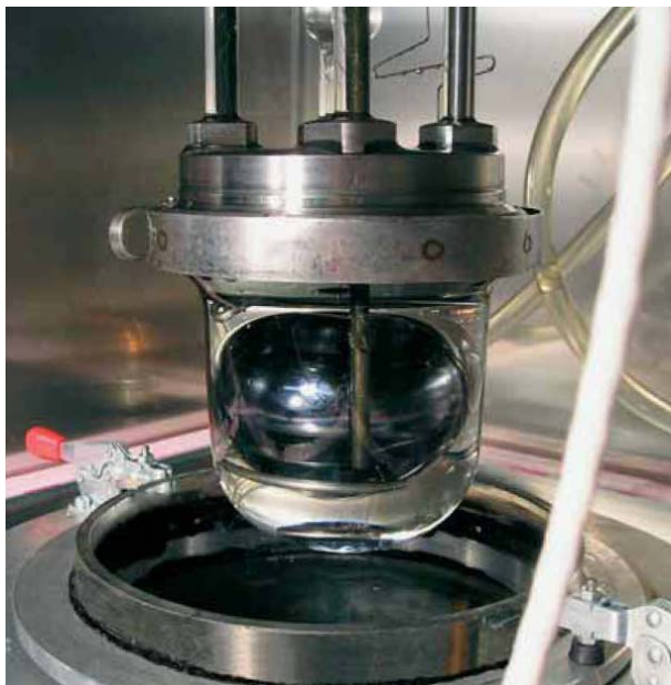
恒温装置升起前装有硅球铅锤的钟形罐
