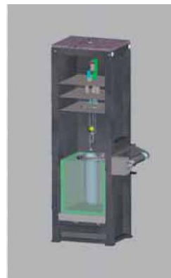
在 CAD 中用于测定固体密度的测试装置
