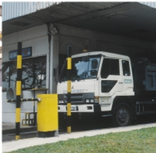
注: 现场图片(槽车秤: 称体镀锌 + 配秤控制 + Zone 1 区防爆)
