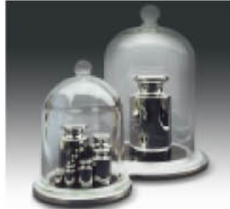
存放 1 mg 到 50 kg 标准砝码的砝码罩
