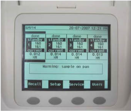
控制模块可连接四组加热模块，同时检定四个样品，增加检定效率，并有优良的重复性
