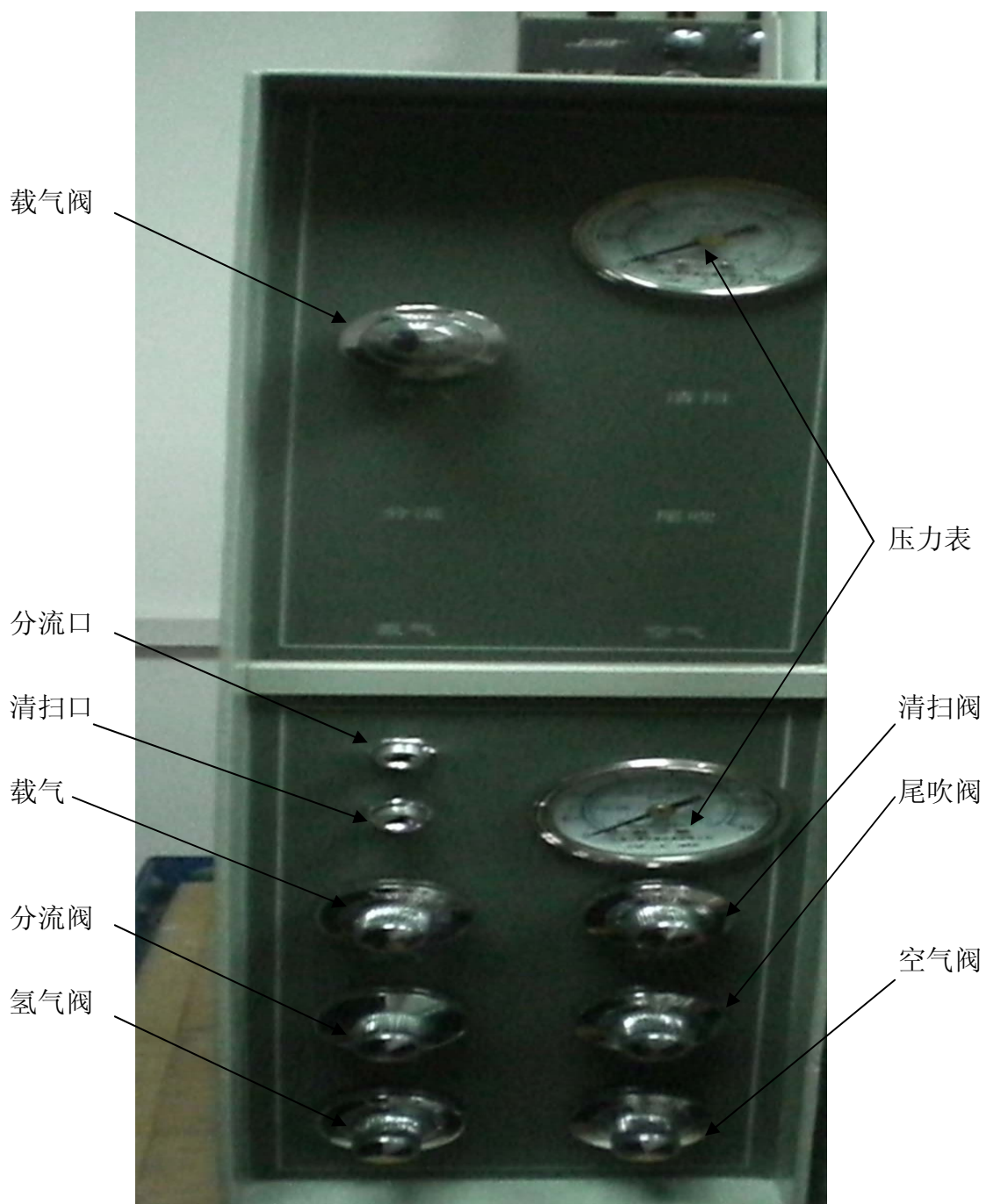
图 2-5 GC-9890A 气路阀件
