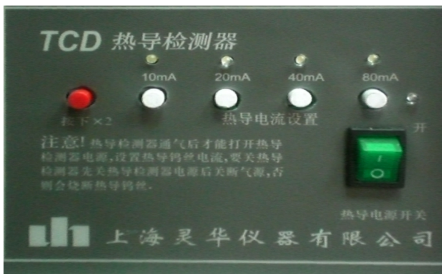
图 6-3 热导检测器桥流开关控制
