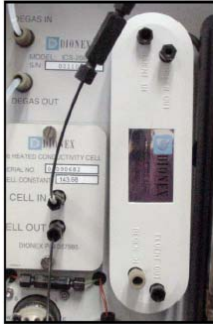
图 62. 抑制器的安装位置
