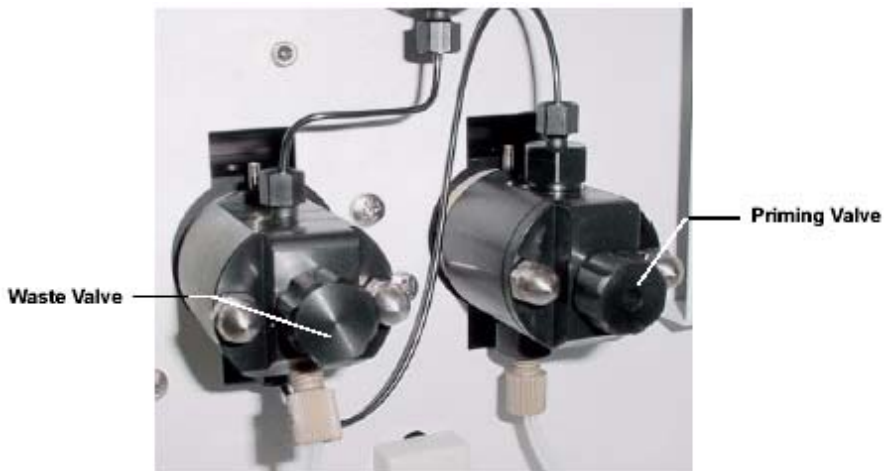
图 35. 启动阀和废液阀
