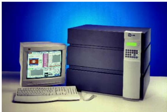
图 2 NETZSCH HFM436 Lambda 热流法导热仪，适用于绝热材料。
