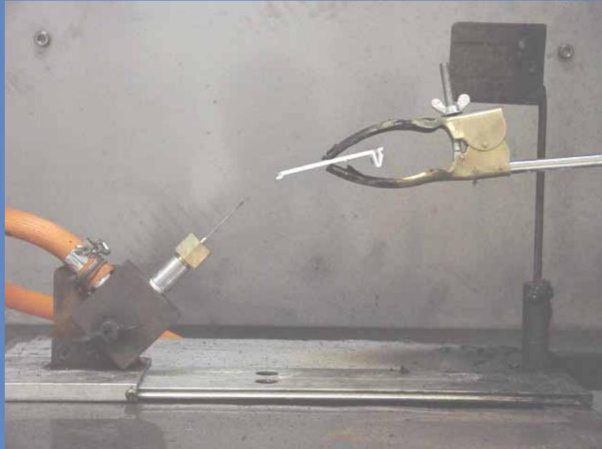
火焰高度  $12\text{mm} \pm 1\text{mm}$
