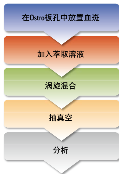
图2. 采用Ostro 96孔板的干血斑萃取流程。
